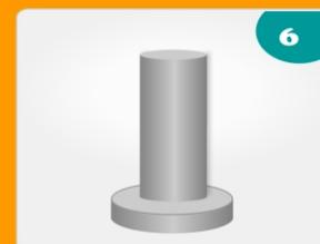
6 Depois do concreto seco, as formas podem ser retiradas, cortando-as com estilete, serra mármore, ferramentas similares ou molhando-as para facilitar a remoção.
