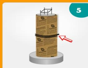
5 Prender a 2ª forma com arame ou fita adesiva resistente na área dos 20 cm do concreto seco e proceder a concretagem do restante da coluna.
