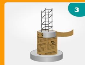
3 Após a secagem, cortar aproximadamente 20 cm da forma com estilete, serra mármore ou equipamento similar.
